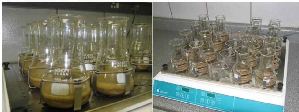
Evaluación de la hidro-estabilidad de pellets para camarón en el laboratorio utilizando el método de agitación horizontal. Fotos de Darryl Jory.
