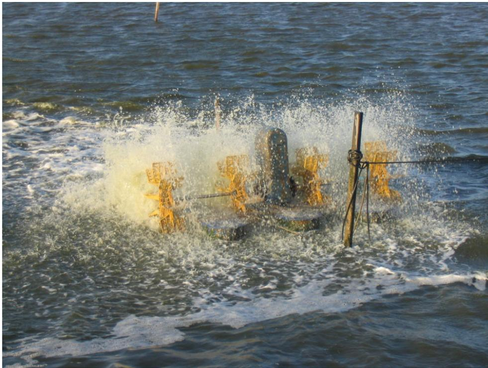
La aireación mecánica aumenta la tasa de pérdida de oxígeno de los estanques cuando el agua está sobresaturada con este gas, y también puede usarse para prevenir y manejar los niveles de oxígeno disuelto.
