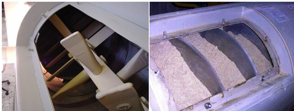
Vistas de las zonas de mezclado (izquierda) y de retención (derecha) en un pre-acondicionador comercial. Fotos cortesía de California Pellet Mill.
