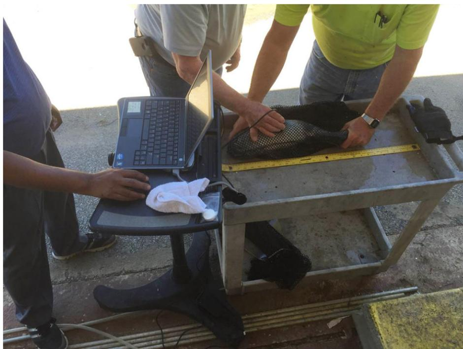
Obtención de una exploración espectral desde un espectrómetro portátil microNIR Onsite hasta la etapa de madurez en hembras de bagre de canal mantenidas en una bolsa de malla blanda en condiciones de granja.
