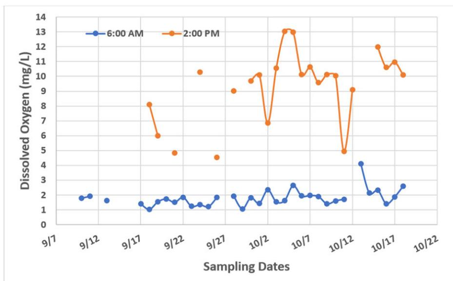
Fig.2: Lecturas de oxígeno disuelto del raceway 2 a las 6 a.m. y a las 2 p.m. durante el estudio de IPRS.
